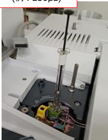
分析装置の注入口
