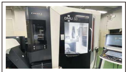
5軸加工機 (5軸マシニングセンタ) 航空機部品をはじめ、船舶のプロペラなど、滑らかな曲面加工などができる機械です。
