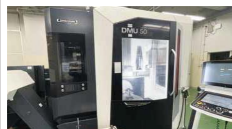
5軸加工機 (5軸マシニングセンタ) 航空機部品をはじめ、船舶のプロペラなど、滑らかな曲面加工などができる機械です。
