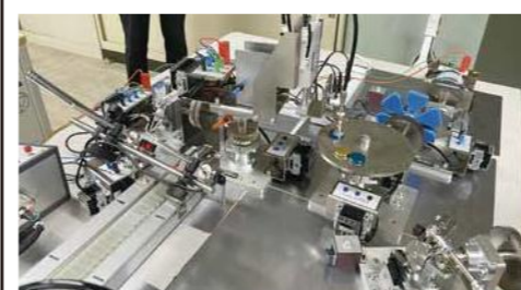
メカトロニクス技術実習システム ロボットやベルトコンベアなどを組み合わせて、メカトロニクスの基礎から応用まで幅広く学べる装置です。
