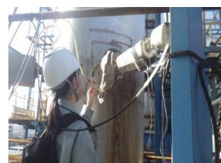
検査のために処理施設から排ガス採取
