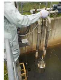
堺第7-3区環境調査 (浸出水の採取)
