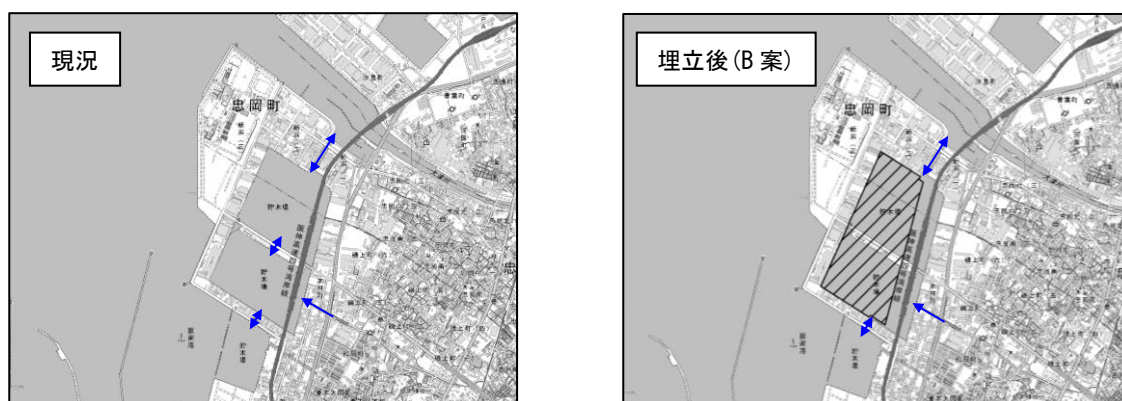
図 4.3-1 阪南港木材港地区貯木場における水の流れ（流出入）の模式図
