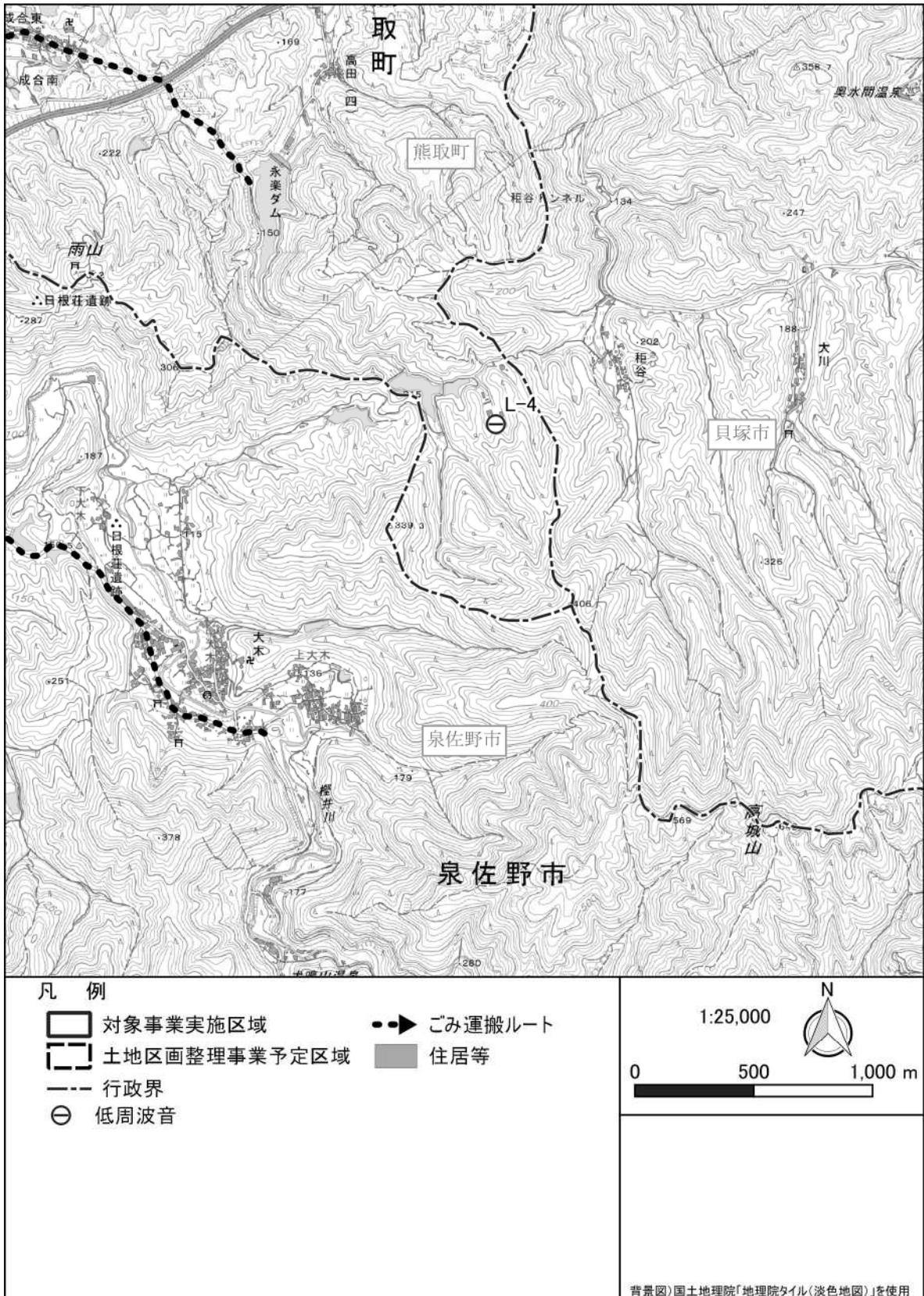
図 7. 5 - 1 ( 4 ) 低周波音の現地調査地点 ( 拡大図 : L-4 )
