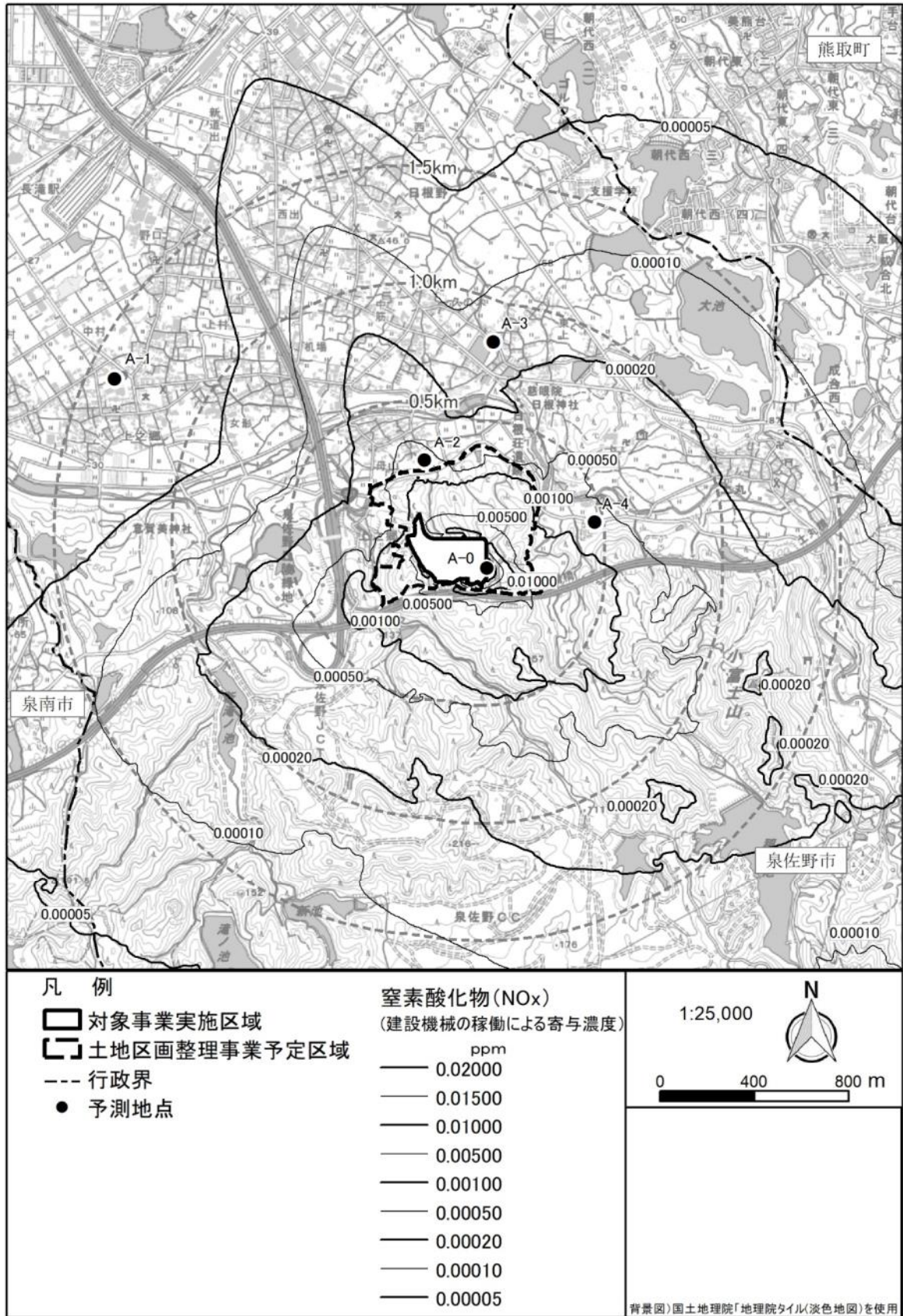
図7. 1-4-1 建設機械の稼働による窒素酸化物の寄与濃度の予測結果
