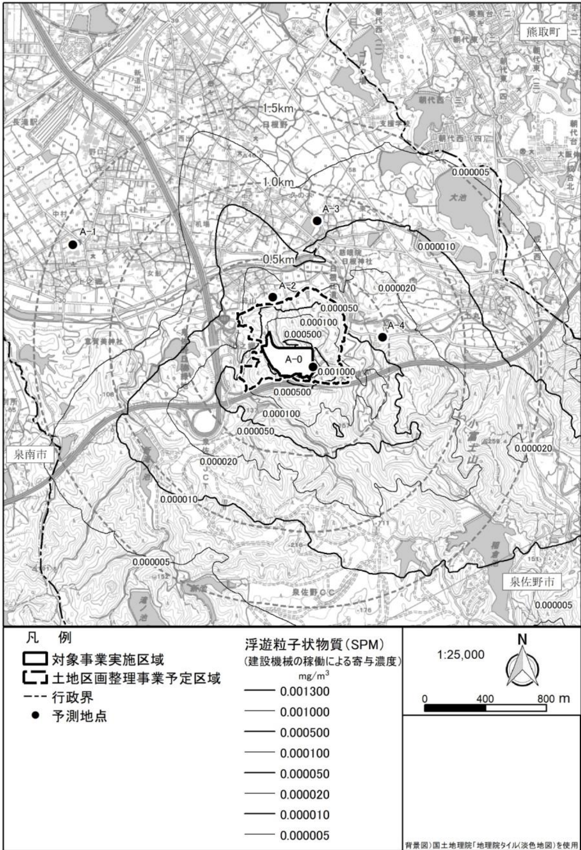
図7. 1-42 建設機械の稼働による浮遊粒子状物質の寄与濃度の予測結果
