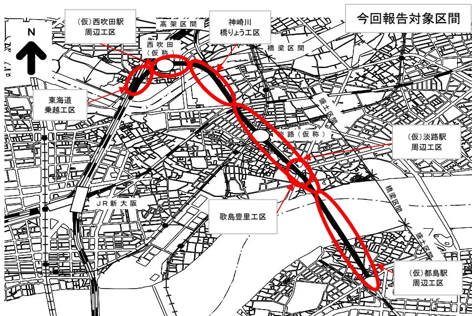
なお、工事工程全般としては、歌島豊里工区は平成 23 年度に施工を終了しておりますが、東海道乗越工区が平成 22 年度から着手しており、平成 27 年度は東海道線他の基礎杭の施工や高架橋の施工などを行いました。また、それ以外の工区は全て平成 24 年度着手であり、平成 27 年度においては、(仮)西吹田駅周辺工区は高架橋の上部工や階段工、神崎川橋りょう工区は神崎川橋りょうの上部工や盛土工事、(仮)淡路駅周辺工区は既設盛土撤去した上での高架橋の構築、盛土部での高らん工、城東貨物線の橋りょう改築、(仮)都島駅周辺工区は既設盛土撤去、盛土部での高らん工、城東貨物線の橋りょう改築などを施工しております。工事工程表は次頁に示すとおりです。
