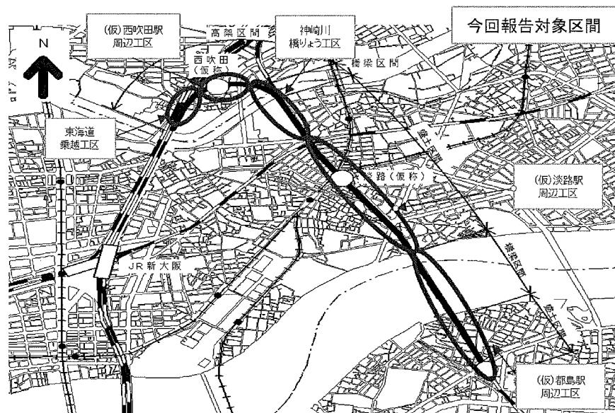
なお、工事工程全般としては、歌島豊里工区の状況は平成23年度に施工を終了しておりますが、東海道乗越工区が平成22年度から着手しており、平成24年度は高架橋の下部工・上部工、東海道線の架道橋改築などを行いました。また、それ以外の工区は全て平成24年度着手であり、西吹田駅周辺工区は高架橋の下部工・上部工、神崎川橋りょう工区は神崎川橋りょうの下部工、淡路駅周辺工区、都島駅周辺工区は盛土などを施工しております。工事工程表は下記に示すとおりです。
