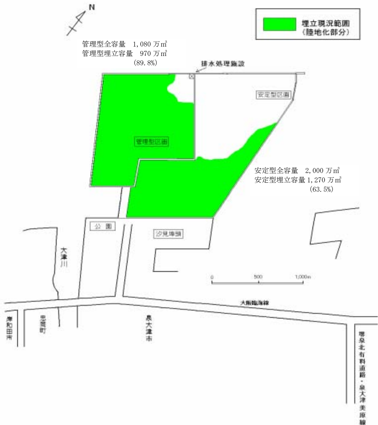
図 2-1-5 埋め立て進捗状況図(平成 16 年 3 月末現在)
