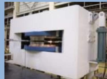
サイクロトロン加速器ベース熱外中性子発生装置。2012年に治験開始。(世界初の加速器を用いたBNCT照射装置)
