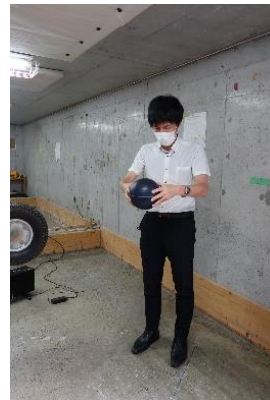
重量床衝撃源（ゴムボール）
