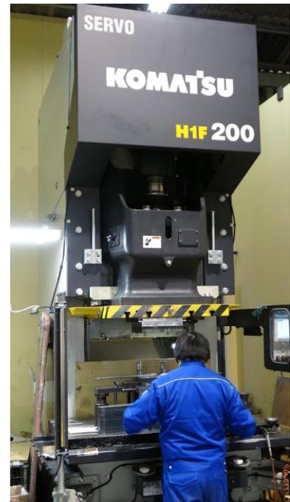
サーボプレスとは…サーボモータ（※）を駆動源とするプレス機。油圧式と比べ立ち上がりの速度が速く、また、加圧方法を任意で設定できることから、従来のプレス機では加工が困難とされてきた難加工材を扱うことが可能。サーボモータ（※）…回転数、角度、位置等を設定することができ、精密な制御ができるモータのこと。
