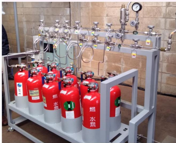
小型水素容器充填温度制御式 多連型充填システム
