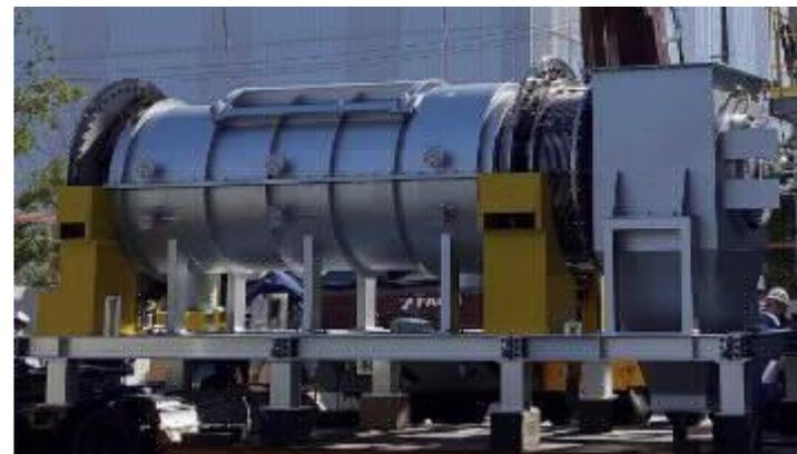
熱分解ガス化改質炉
