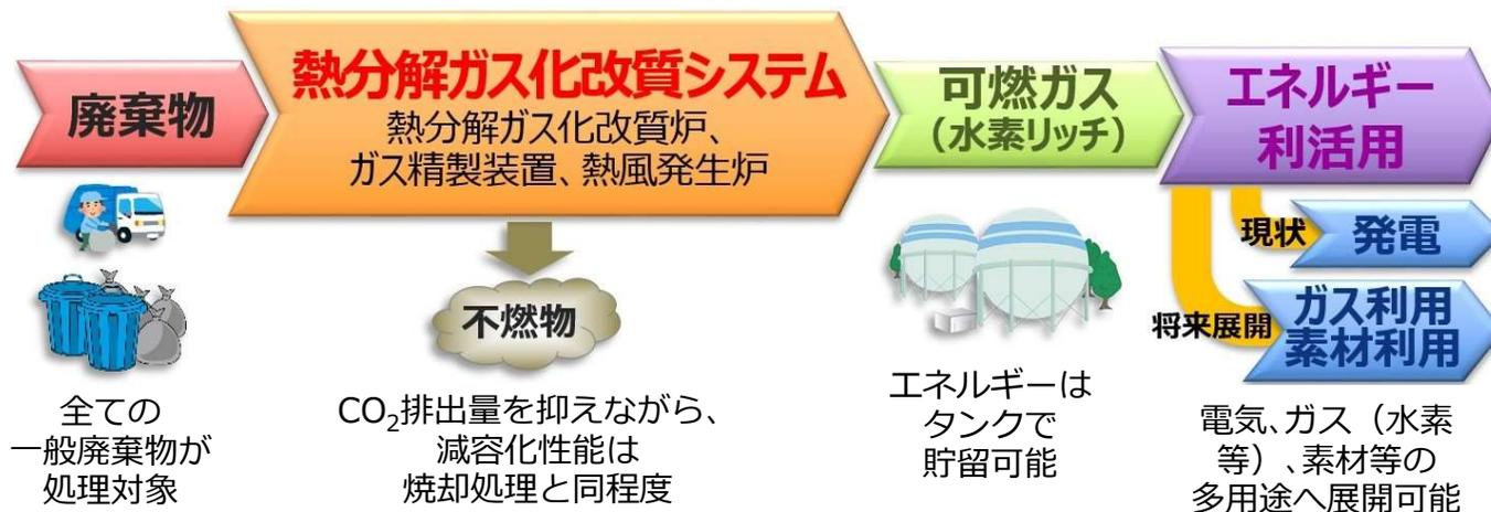
ごみを高温の無酸素状態で攪拌することで、ごみ中の可燃物を可燃ガスに変換するシステム
