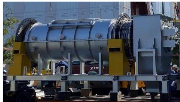
熱分解ガス化改質炉
