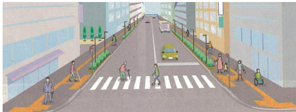
点字ブロックの設置
