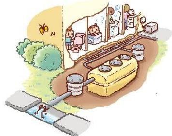
合併処理浄化槽設置イメージ
