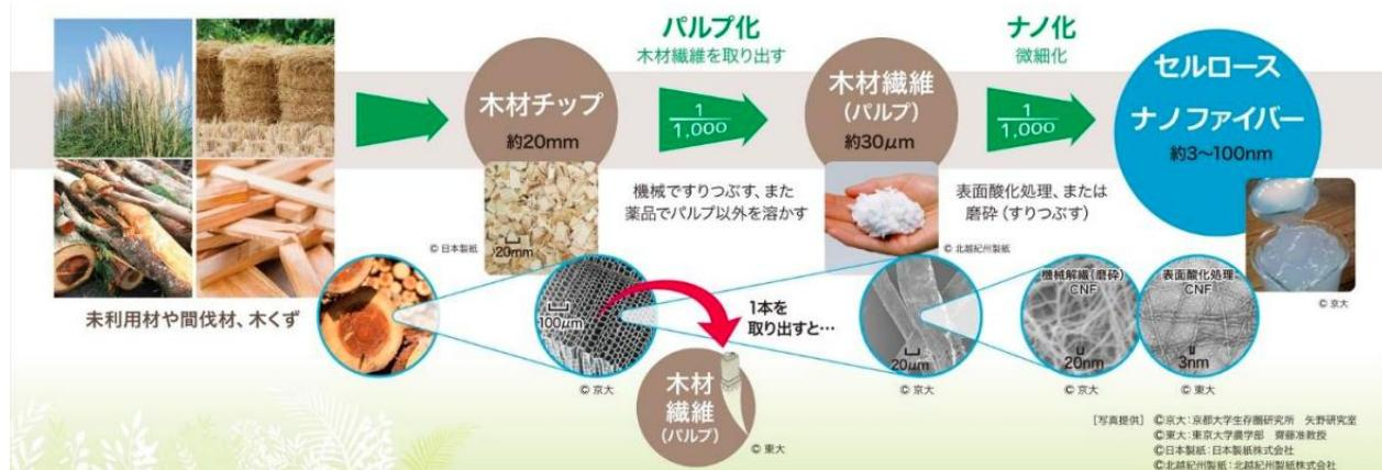
セルロースナノファイバー製造の概要図
