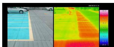
太陽熱の高反射舗装
