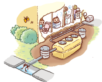
合併処理浄化槽設置イメージ
