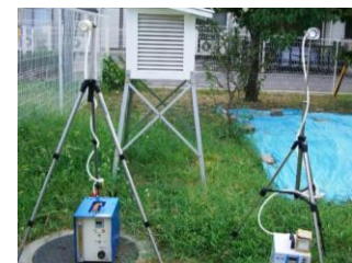
大気中の石綿濃度測定
