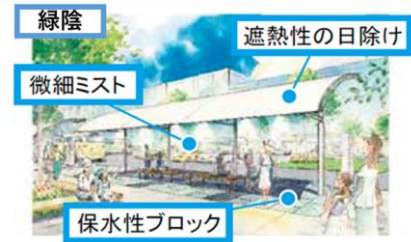
駅前広場での猛暑対策のイメージ （出典：まちなかの暑さ対策ガイドライン 改訂（一部加工））
