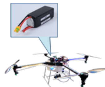
農業用マルチコプターの 高出力バッテリー
