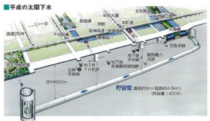
図 8 北浜逢阪貯留管（愛称：平成の太閤下水）の概要（大阪市提供資料）
