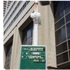
二酸化窒素濃度の簡易測定
