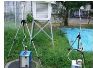
大気中の石綿濃度測定
