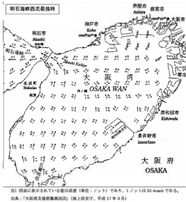
図 2-2 大阪湾の潮流 (明石海峡西流最強時) (平成 18 年 2 月 神戸市「神戸港港湾計画資料その 2」)
