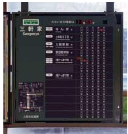
図 4-5-1 バス接近表示器 [大阪市提供]
