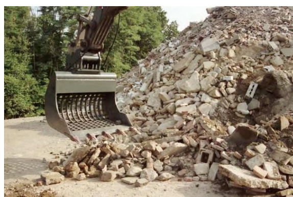
図6 スクリーンのみが揺動するスケルトンバケット [6]
