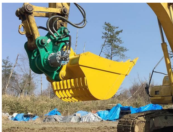
図5 油圧モーターにより駆動するスケルトンバケット [5]
