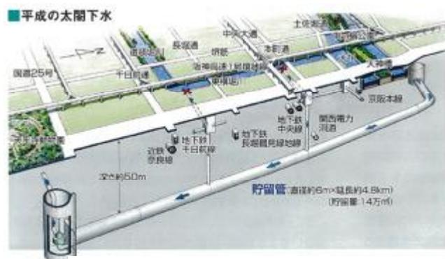
図33 北浜逢阪貯留管（愛称：平成の太閤下水）の概要（大阪市提供資料）
