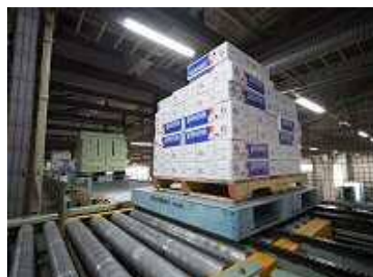
輸送コンベア(自動輸送装置)
