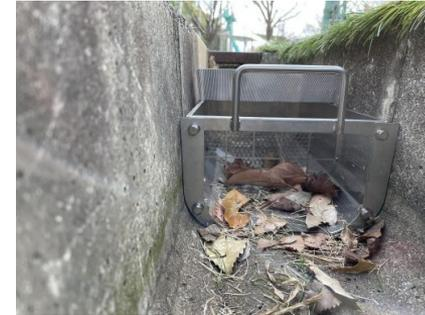
フィルター設置によるMP補足状況確認
