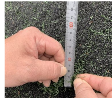
パイル長測定
