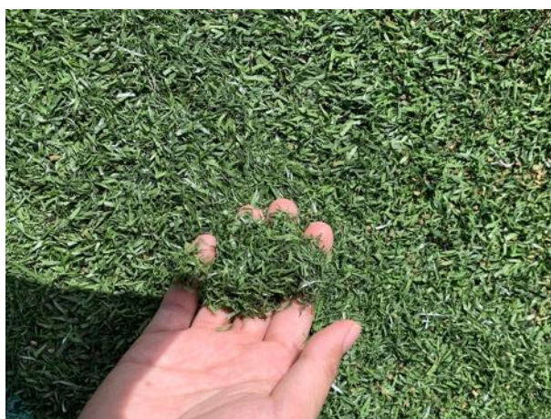
グラウンドに堆積した人工芝片
