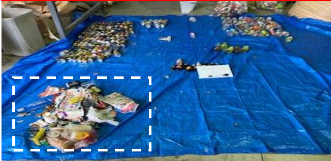
組成分析例 従来型リサイクルボックスに排出された内容物 (点線内が異物)
