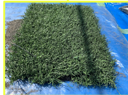
②PK軸足：ゴムチップ・目砂吸引 ※芝張替時に測定
