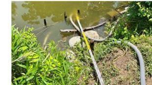
【補足】水位変動に対応できるように、吸込部にフロートを付けるとよい。
