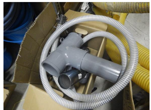
写真2 TS チーズ (塩ビ管のみ接続後・φ75mm)
