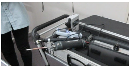
<室内空気環境測定（CO 2 ほか5項目）>
