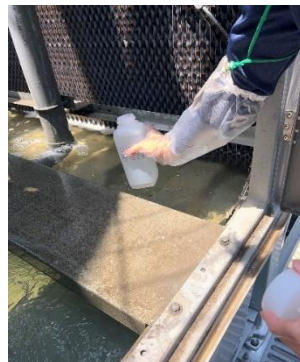
【冷却塔の水質検査】
