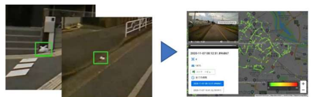
①車載のスマホで車道を撮影、機械学習でごみの数や種類を解析
