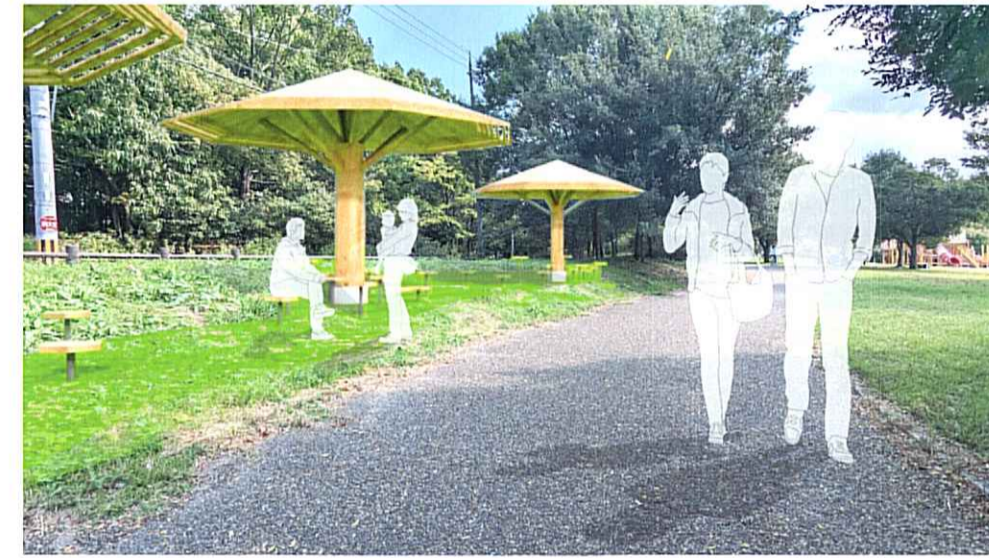
園路に沿って3つの屋根を配置し、中央を大きく左右を小さくしている。スツールは柱を中心に左右に広がるように設置し、季節や時間に応じて日陰の部分と日なたの部分をつくる。
