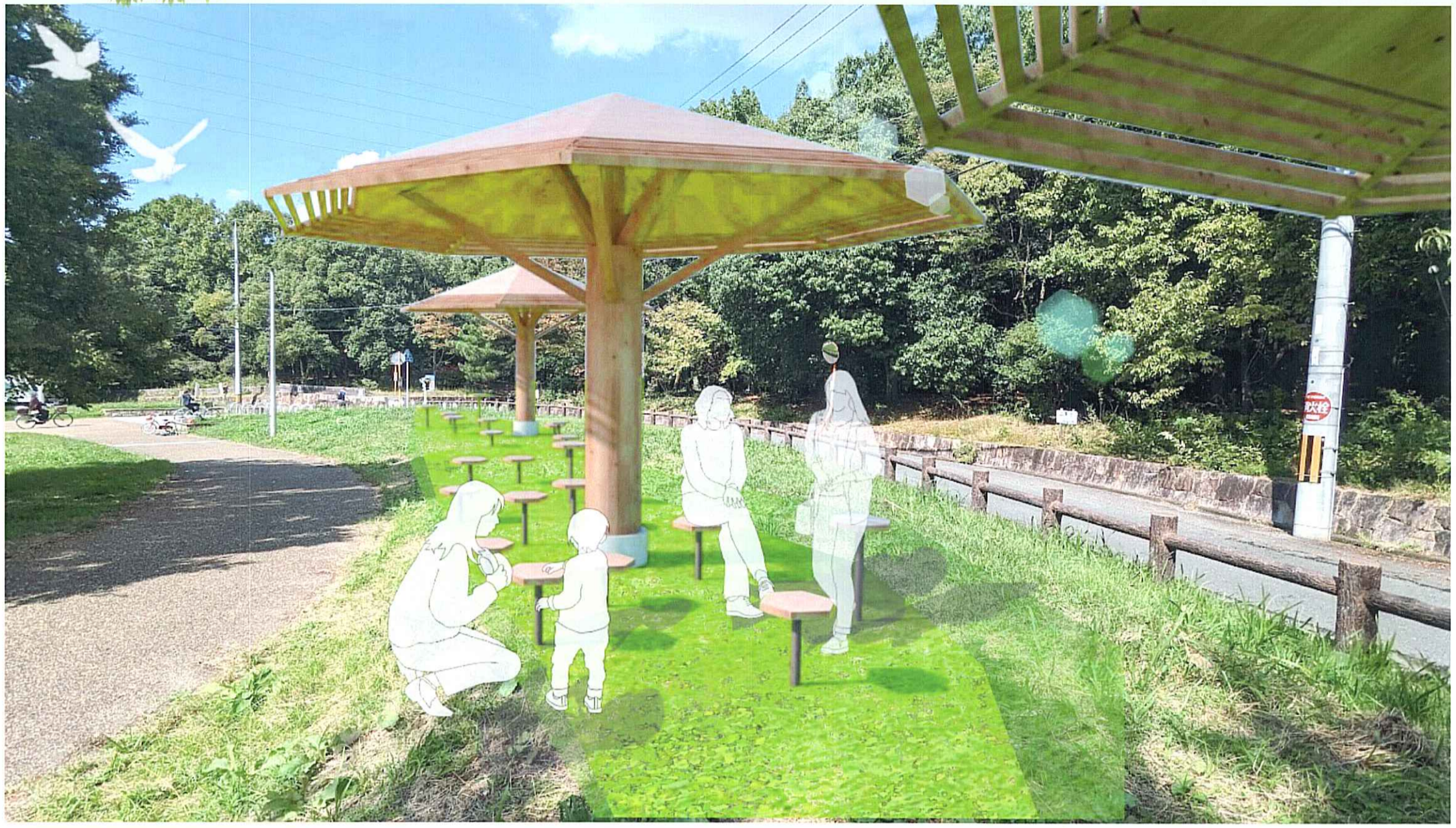
園路に沿って3つの屋根を配置し、中央を大きく左右を小さくしている。スツールは柱を中心に左右に広がるように設置し、季節や時間に応じて日陰の部分と日なたの部分をつくる。
