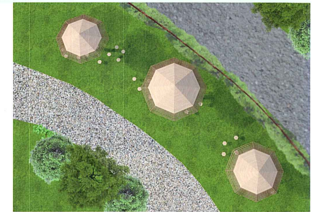
園路に沿って3つの屋根を配置し、中央を大きく左右を小さくしている。スツールは柱を中心に左右に広がるように設置し、季節や時間に応じて日陰の部分と日なたの部分をつくる。
