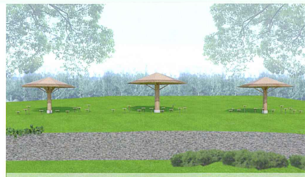
園路に沿って3つの屋根を配置し、中央を大きく左右を小さくしている。スツールは柱を中心に左右に広がるように設置し、季節や時間に応じて日陰の部分と日なたの部分をつくる。
