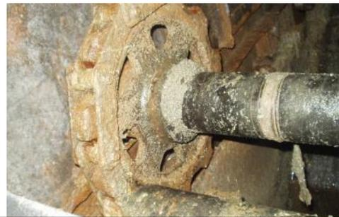
経年劣化による錆発生および腐食摩耗
