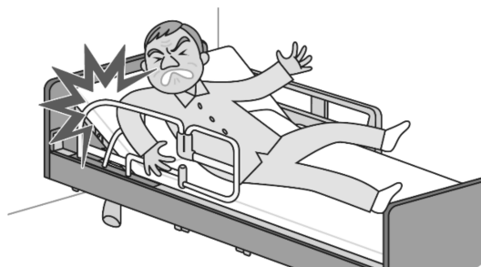
手すり等の中に挟まる事故
