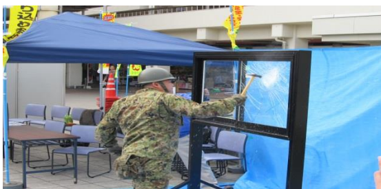
防犯ガラスの破壊実験
