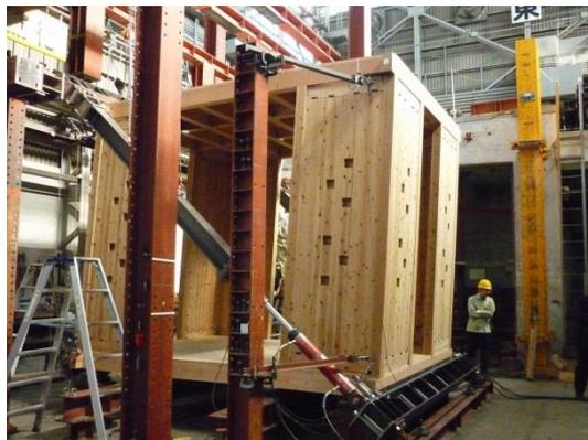
圧縮載荷試験については、1,515kNの耐力を保持していることがわかった。また、斜め載荷試験については途中で一部の梁に損傷があり、98kNで試験を終了したが、通常の想定上載荷重の2.5倍に相当する十分な耐力を保持していることがわかった。また試験終了時にも壁柱の損傷はほとんどなく、その静的上載荷重の保持能力には全く問題がなかった。
