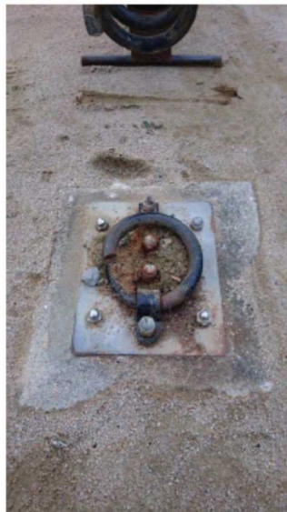
根本破断状況
