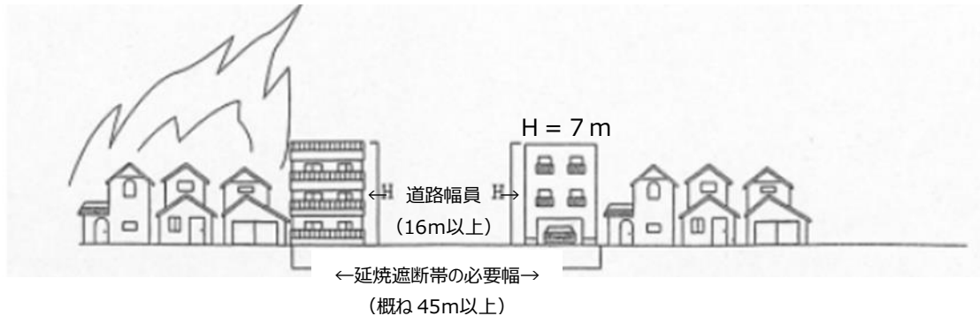
図 3-2-17 延焼遮断帯の整備イメージ（空地＋耐火建築物で確保する場合（両側耐火））
