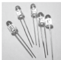
*上の発光ダイオードの全長は約35mm、発光部は約9mm。
