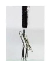
・電磁石を強くするためには、流す電流を( 強く ) したり、
