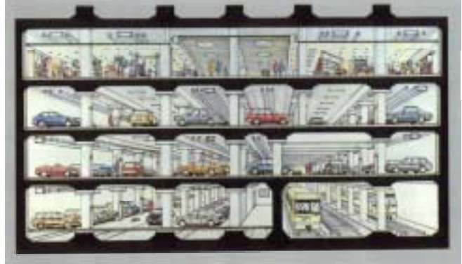
クリスタ長堀(大阪市) 約8haの地下街 商業施設、道路や駐車場などを立体的・複合的に整備
