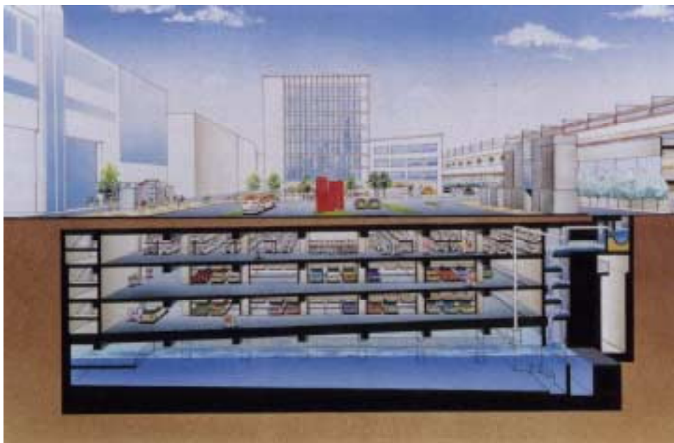
布施駅前北口広場の地下に、駐車場と流域調整池を一体的に整備
