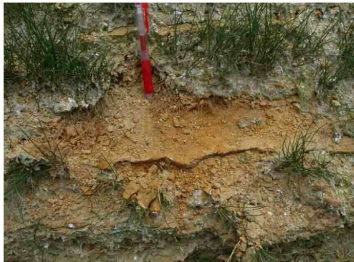
地層の走向傾斜はN10W,13W方向を示す
