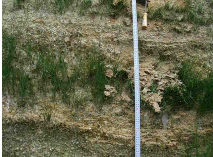
粘土層は平滑な半固結状態の層が幾層も重なる
