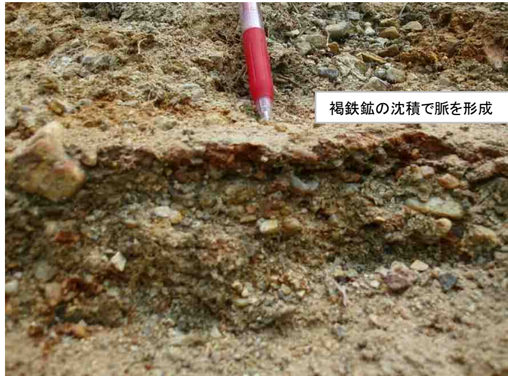
褐鉄鉱が沈積した堆積面は過去に地下水の流れの跡、おおそN10E,20W方向
