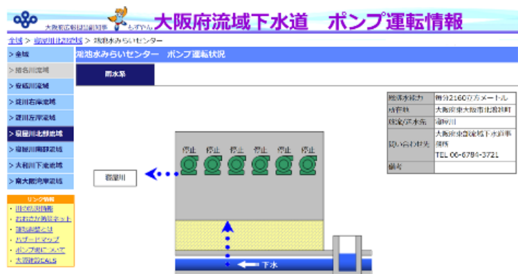
図 31 雨水ポンプ運転情報公開画面の例
