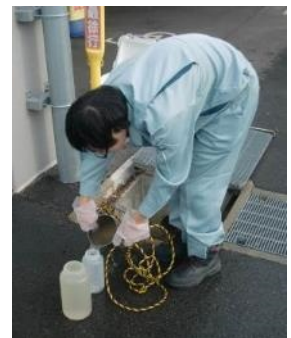
事業所排水の採水検査
