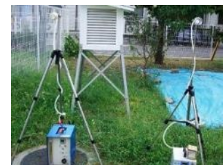
大気中の石綿濃度測定
